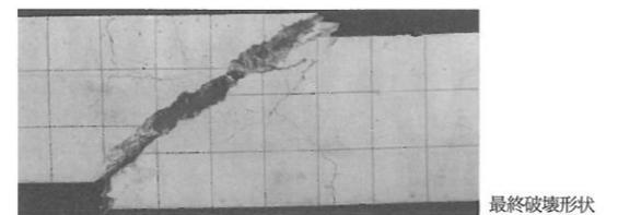
実験結果は、コンクリートの幅によりせん断耐力が異なることが明らかとなったことから、コンクリートの有効幅の影響を考慮した簡便なせん断耐力式を提案した。提案式は、実験結果を精度よく評価できており、CES部材の終局せん断耐力を、内蔵鉄骨・断面幅の差異によらず評価できることを明らかにした。
