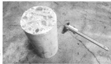
コンクリート試供体とノギス
