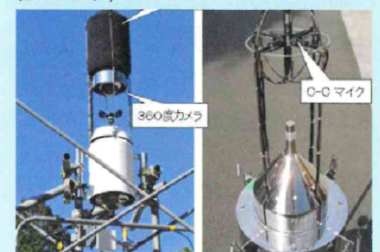
下左/「音ジャッジ」の監視用センサー。下右/方向判別する C-C マイク (写真は大林組 HP より)
