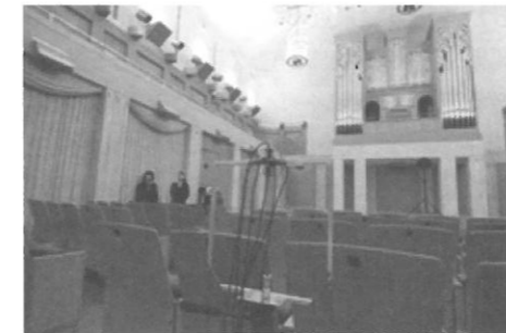
当研究室で開発したマイクによる音楽ホールの反射音到来方向の計測
